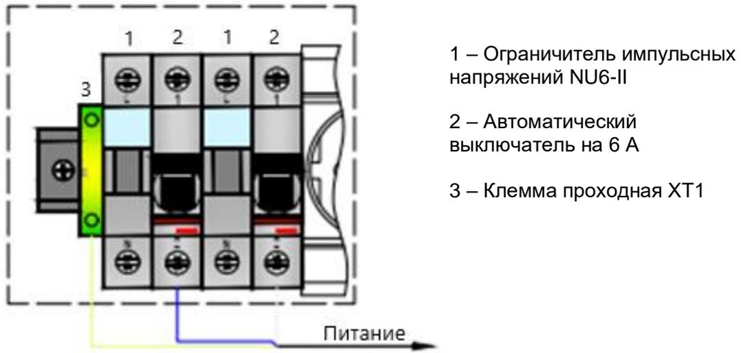
Рисунок 1.2 – Вид Г. Схема электрического подключения
